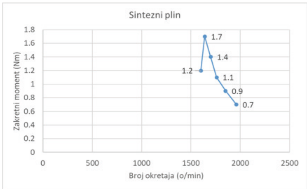
Grafikon 5. Izmjeren zakretni moment motora pogonjenog sinteznim plinom
