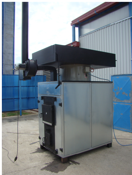
Slika 1. Generator topline „Herbas“
